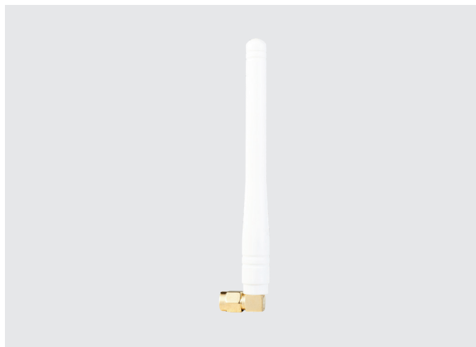
WIFI外接天线 胶棒天线/SMA内针/弯角108mm/ 频率2.4G/G>2DB/VSWR<1.5
