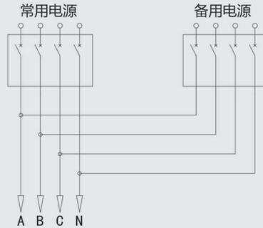
备注：常用电源和备用电源N线均需连接可靠，接错N线可导致控制器烧毁
