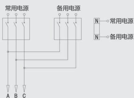
注意：三极产品需要用户外接常用电源N和备用电源N到控制器对应端子，接错或漏接N线将导致产品异常，甚至烧毁控制器
