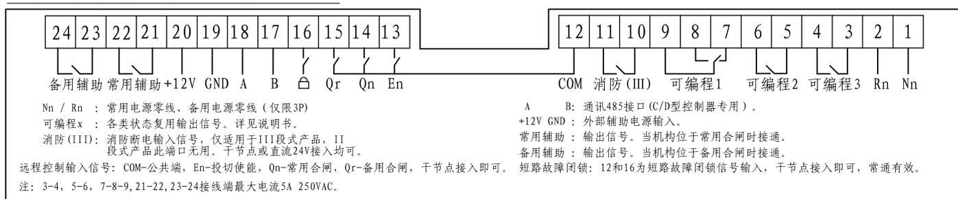
备注: 12与16为短路故障闭锁信号, 干节点无源输入, 长通有效, 收到信号后产品将拒动 (需要特评供货)。
