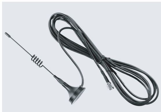
吸盘天线 SMA内针/线长1.5M/ 频率2.4G/G>2DB/VSWR<1.5
