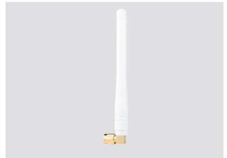
WiFi外接天线 胶棒天线/SMA内针/弯角108mm/ 频率2.4G/G>2DB/VSWR<1.5
